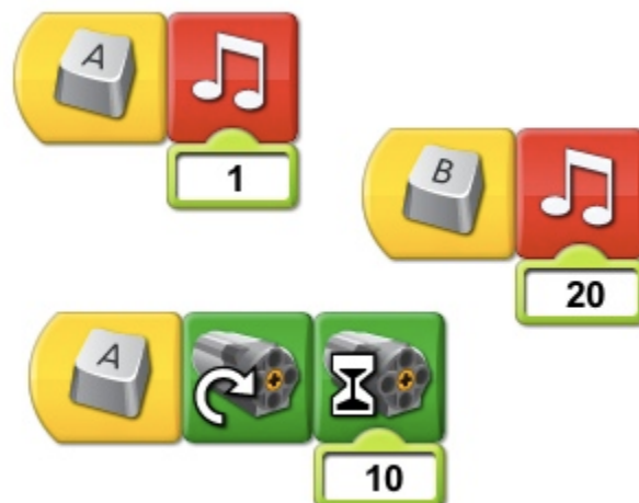
Joonis 4. Programm, mis klaviatuuri 'A' vajutuse korral mängib heli ja samal ajal pöörab mootorit paremale.
